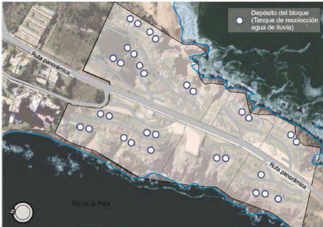
Figura 4-2 Tanques de almacenamiento y amortiguación de agua de lluvia. Estudio Hidrológico informe diciembre 2021 DICA.
